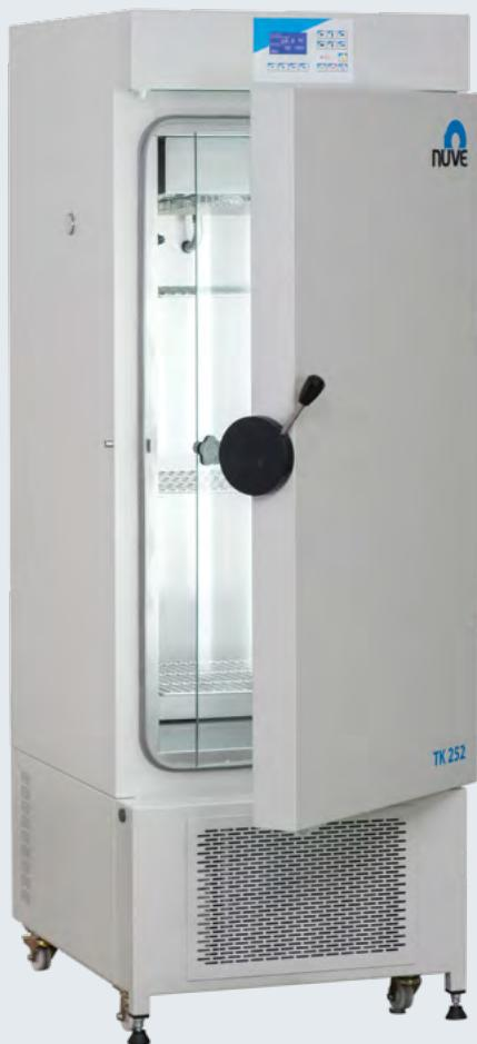
*TK Serisi Test Kabinleri, sıcaklık, nem, aydınlatma / karanlık ışık döngülerini kontrol ederek, gerçek iklim şartlarını canlandırmak amacıyla geliştirilmiştir. TK serisi Test Kabinleri'nin sıcaklık ve nem kontrol aralığı farklı sektörlerde birçok testin yapılmasını sağlar. Bununla birlikte kararlılık, suni yaşlandırma, saklama ve raf ömrü testleri de kolaylıkla yapılabilir. Cihazın mükemmel tasarımı, TK Serisi cihazların birçok farklı sektörde kullanılmasını sağlar:*
